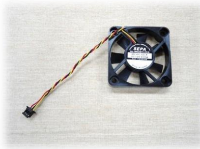
電装部品リード線の端子圧着
