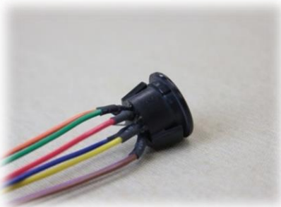
端子ハンダ付け、 収縮チューブ
